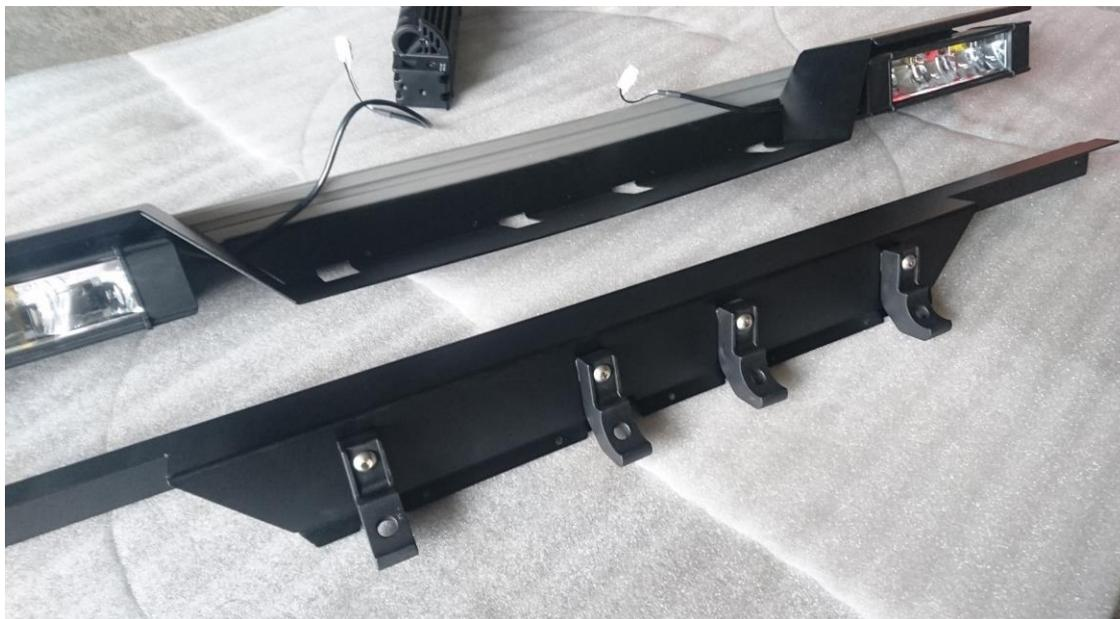
Einfädeln der Anschlusskabel und verdrahten der Scheinwerfer nach gewünschten Vorgaben. Alle Verbindungen werden unter dem Mittelblech untergebracht und die Anschlusskabel unter der Blende nach links und/oder rechts geführt.
